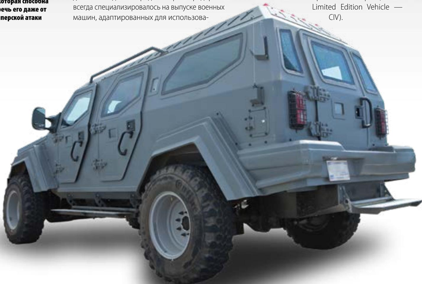
Для съемок «Форсажа 5» был выбран Gurkha LAPV — автомобиль с внедорожными шинами Continental MTR 81, дизельным турбодвигателем V8 объемом 6,7 л и мощностью 330 л.с. Конечно, его вес не позволяет развить высокую скорость, максимум 130 км/ч. Бронированный корпус машины обладает защитой седьмого уровня, самой высокой на авторынке и рассчитанной на атаку снайпера.
